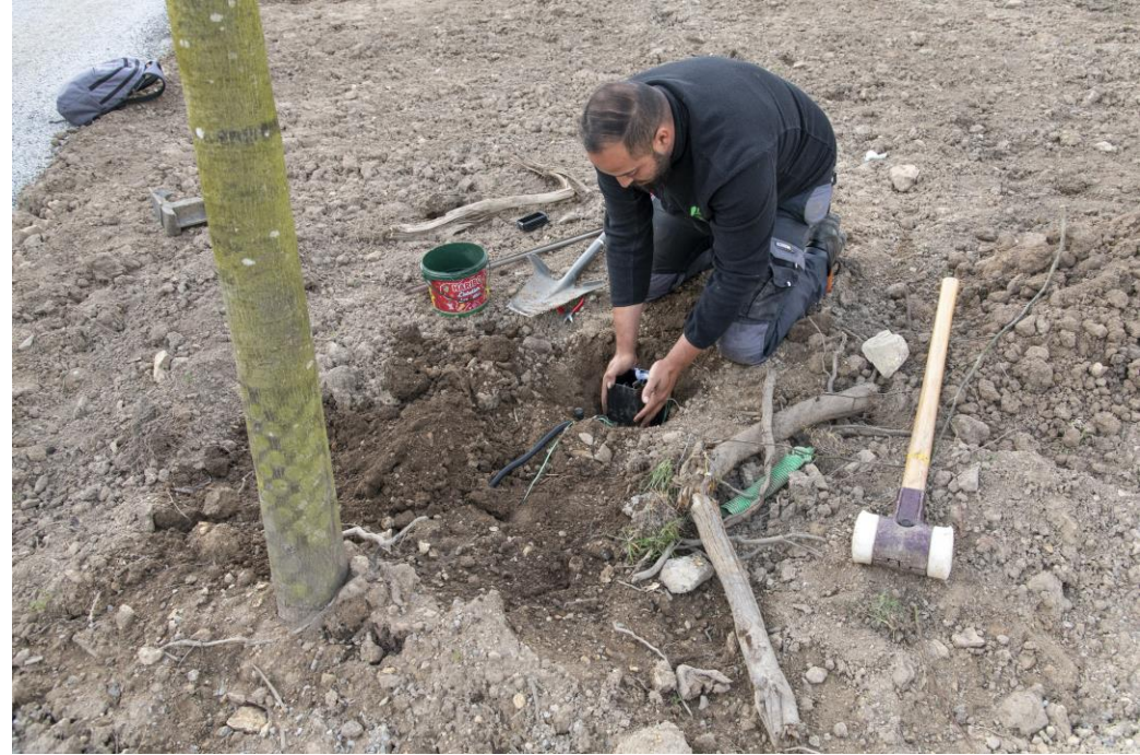
Installation d’une sonde tensiométrique au pied d’un tilleul à La Rabine Elle permettra de connaître les besoins réels en eau et d’apporter la quantité strictement nécessaire.
